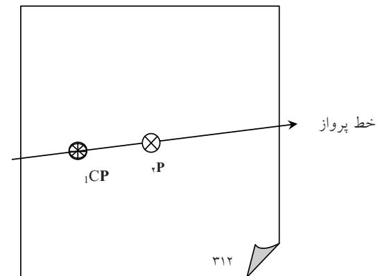
شکل ۱-۴۰-۳: تعیین مسیر پرواز بر روی عکس هوایی
