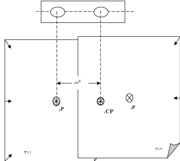
شکل ۱-۴۰-۲: تنظیم فاصله کانونی تقریباً ۶ سانتی‌متری از یک جسم بر روی هر دو عکس متواالی هوایی به منظور بر جسته بینی
