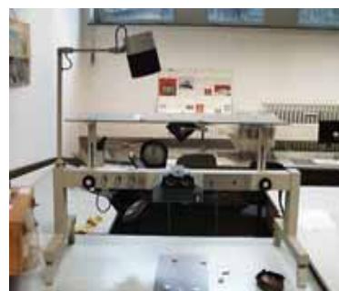
شکل ۲-۲: دستگاه‌های زوم ترانسفرسکوپ سمت راست و زوم استریو ترانسفرسکوپ سمت چپ جزئیات ویژگی‌های پدیده‌های ثبت شده در تصاویر ماهواره‌ای به وسیله دستگاه‌های مزبور بر روی نقشه‌های مبنا پیاده می‌شود.
