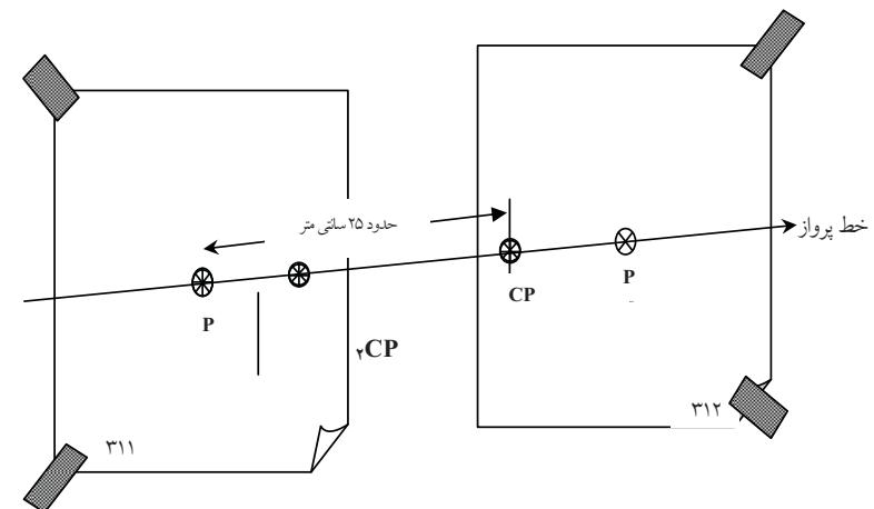
شکل ۴۱-۱: جفت عکس متواالی هوایی آماده شده به منظور برجسته‌بینی با استریوسکوپ آبینه‌دار
