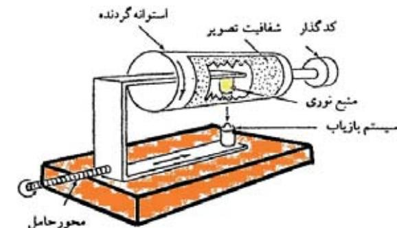
شکل ۳-۲: سیستم استوانه‌ای تبدیل عکس و تصویر به رقم و عدد
